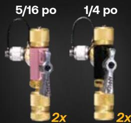
Avec les deux VCRT, vous pouvez retirer facilement les obus des **valves Schrader** de 1/4 po et 5/16 po. Les obus de valve sont **très restrictifs**. En récupération, ils agissent comme un dispositif de dosage qui peut transformer le réfrigérant liquide en vapeur. Mélangé à la chaleur de compression, cela entraîne **une récupération lente et des réservoirs chauds**.
