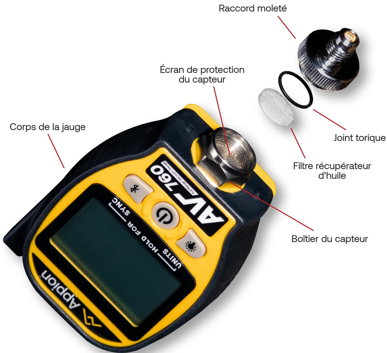
Utiliser un nettoyant électronique à séchage rapide pour nettoyer le capteur de la jauge.
